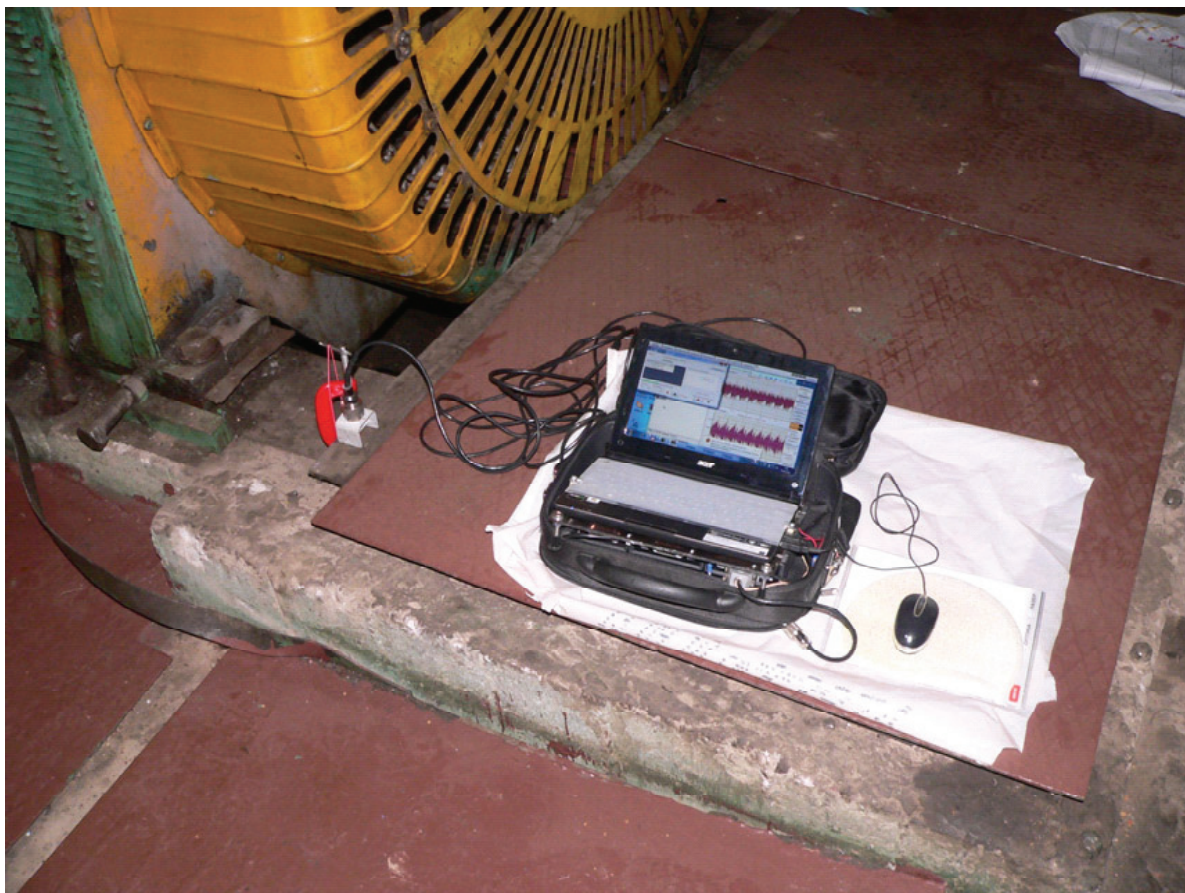
Рисунок 3. Измерения параметров колебаний фундамента компрессора.
