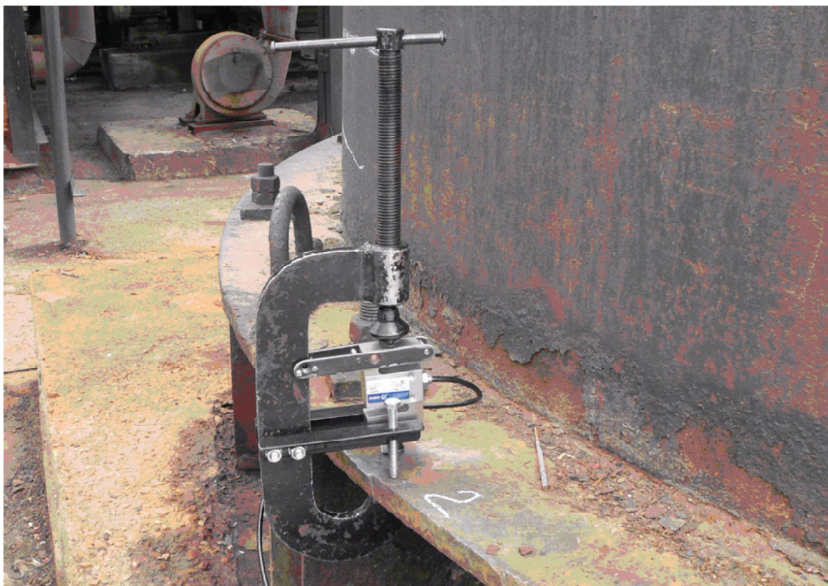
Рисунок 4. Определение твердости стали по Бринеллю с помощью портативного твердомера оригинальной конструкции.
