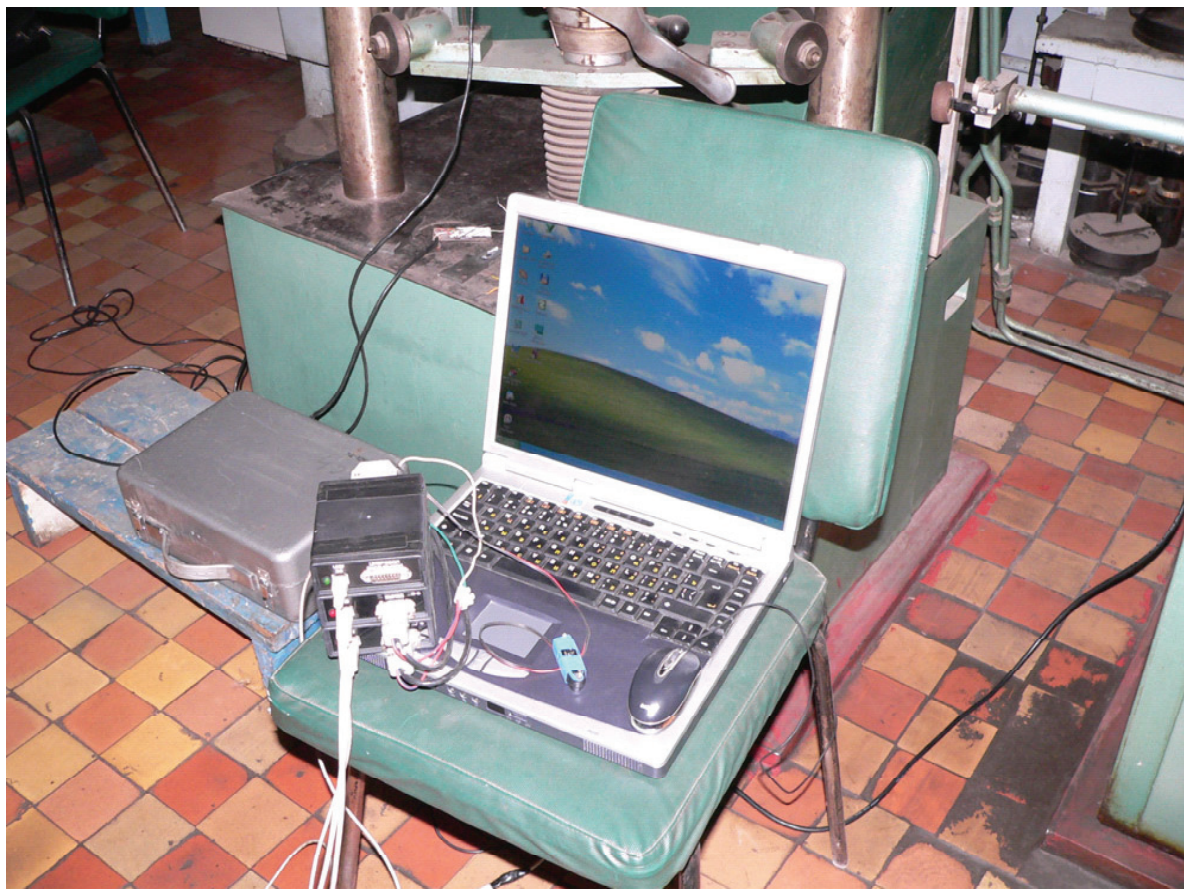
Рисунок 1. Портативный информационно-измерительный комплекс на базе модуля ZET 210.
