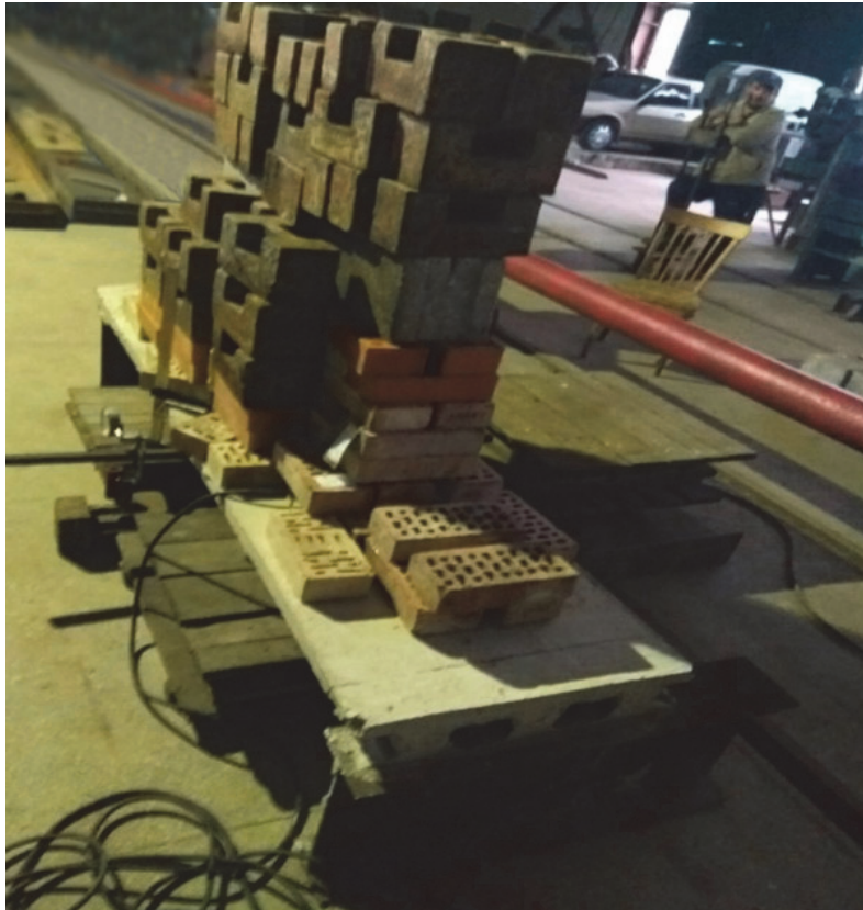
Рисунок 6. Вид плитной конструкции под нагрузкой при 23-й ступени загрузки.
