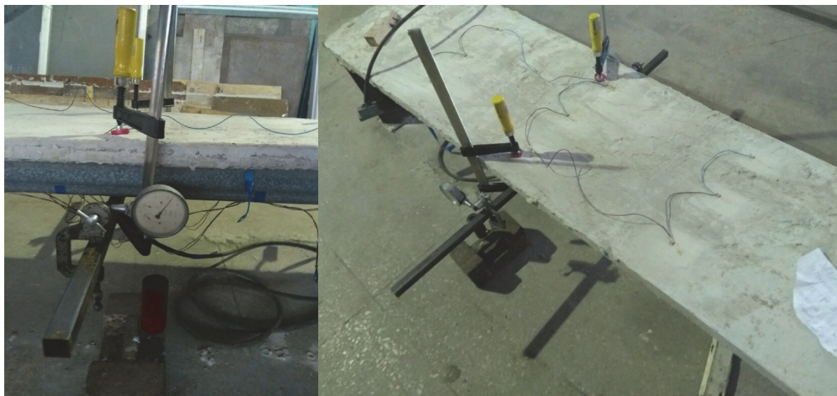
Рисунок 4. Схема установки и вид прогибомеров ПАО-6.
