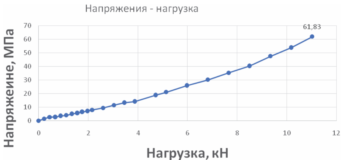
Рисунок 10. Зависимость нормальных напряжений на нижней поверхности профнастила в четверти пролета от нагрузки на плиту (датчики № 7, 8, 9).
