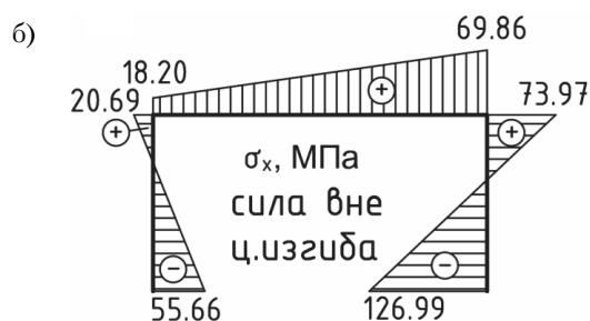
Рисунок 4. Эпюры нормальных напряжений вдоль оси для балки с поперечным сечением в виде швеллера: а) сосредоточенная сила приложена в центре изгиба (эпюра напряжений соответствует эпюре напряжений от изгибающего момента); б) сосредоточенная сила приложена вне центра изгиба (эпюра напряжений соответствует суммарной эпюре напряжений от изгибающего момента и бимоента); в) разность между суммарной эпюрой и эпюрой от изгибающего момента (соответствует эпюре от бимоента).
