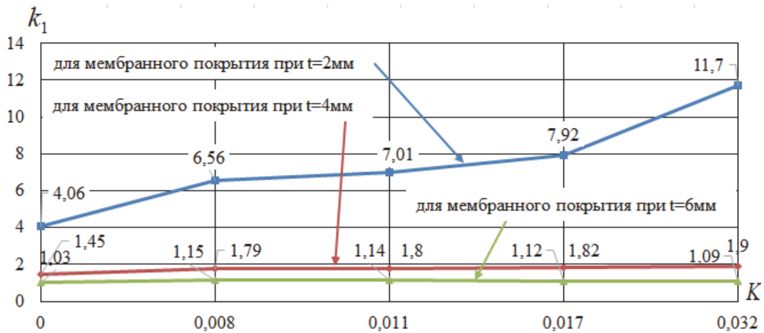
Рисунок 15. Зависимость k_1 от жесткостных характеристик EI_p / Db_M и кривизны мембранной оболочки K .
