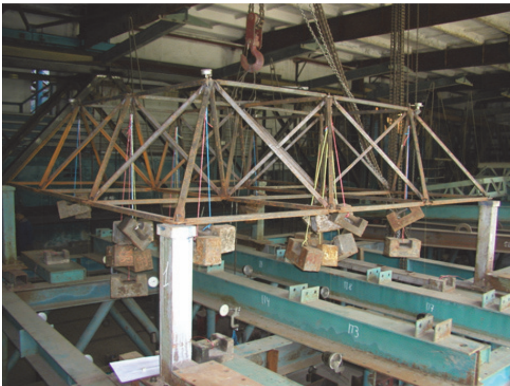
Рисунок 7. Подвеска грузов к узлам верхнего пояса фрагмента структуры.
