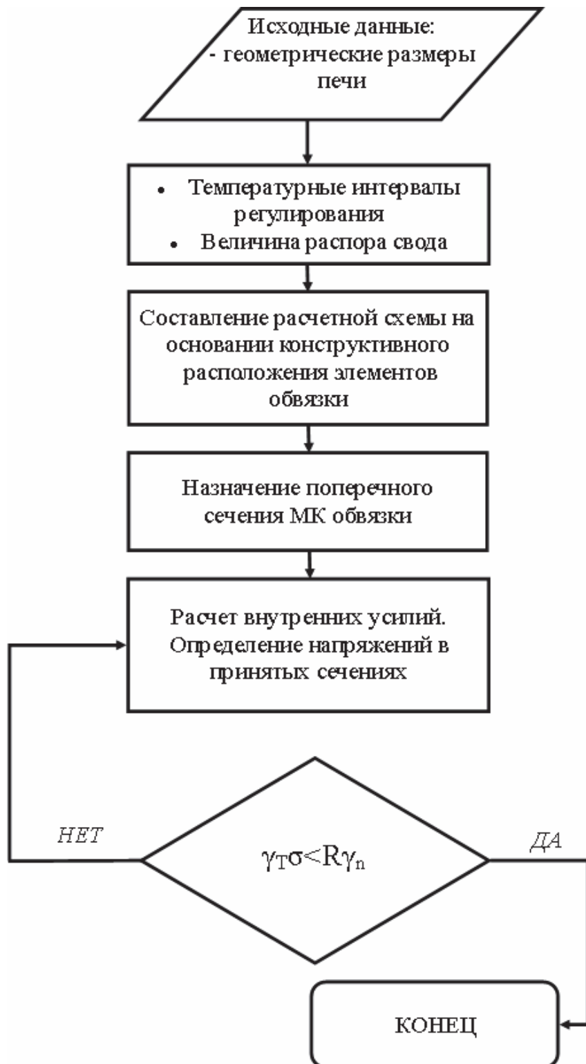
Рисунок 16. Блок-схема алгоритма расчета конструкций металлического каркаса обвязки стекловаренной печи.
