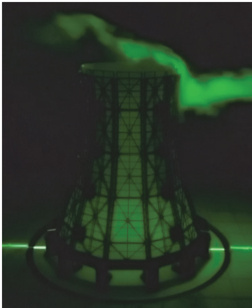
Рисунок 28. Визуализация обтекания ветрового потока относительно плоскости XOZ при подаче дыма на вытяжную башню.
