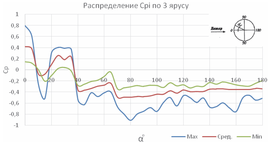
Рисунок 14. Распределение C_{pi} по внешнему контуру третьего яруса при направлении ветра на грань (монтажная стадия – замыкание карт третьего яруса).
