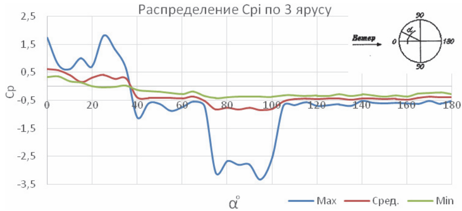
Рисунок 9. Распределение Sr_1 по внешнему контуру третьего яруса при направлении ветра на грань (монтажная стадия – замыкание карт четвертого яруса).
