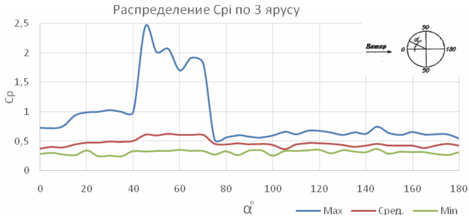
Рисунок 10. Распределение Sr_1 по внутреннему контуру третьего яруса при направлении ветра на грань (монтажная стадия – замыкание карт четвертого яруса).
