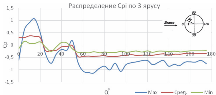
Рисунок 16. Распределение C_{pi} по внешнему контуру третьего яруса при направлении ветра на ребро (монтажная стадия – замыкание карт третьего яруса).
