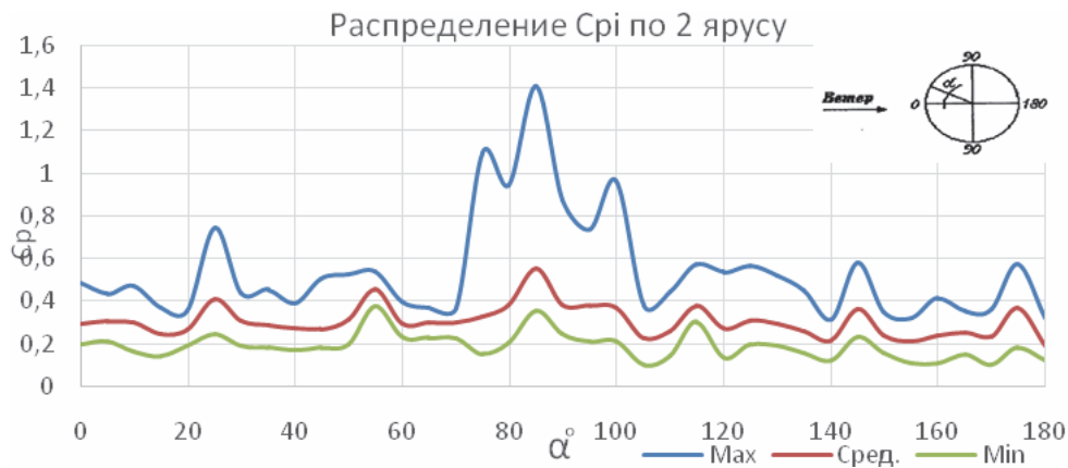
Рисунок 20. Распределение C_{p_i} по внутреннему контуру третьего яруса при направлении ветра на грань (монтажная стадия – замыкание карт второго яруса).
