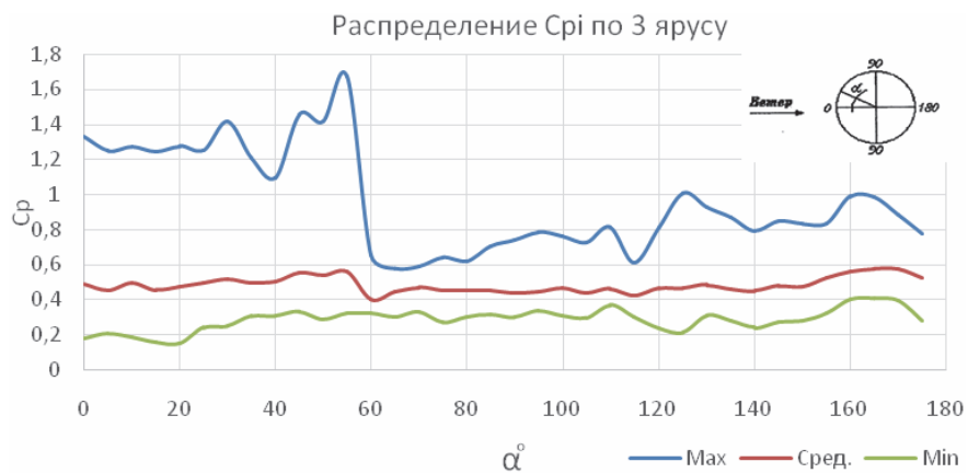
Рисунок 12. Распределение C_{p1} по внутреннему контуру третьего яруса при направлении ветра на ребро (монтажная стадия – замыкание карт четвертого яруса).
