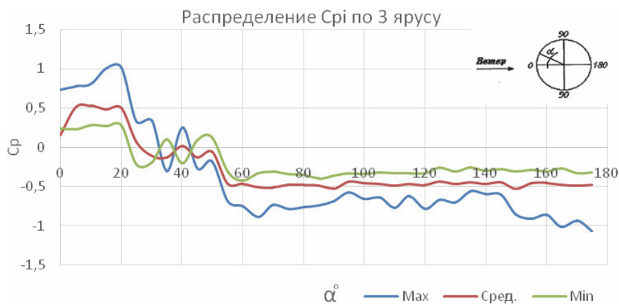
Рисунок 11. Распределение Sr_1 по внешнему контуру третьего яруса при направлении ветра на ребро (монтажная стадия – замыкание карт четвертого яруса).
