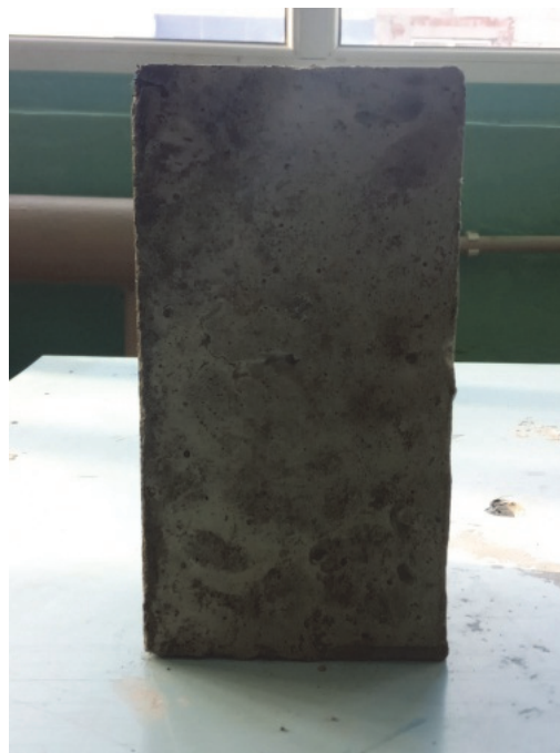
Рисунок 1. Испытуемая призма из бетона класса В15.
