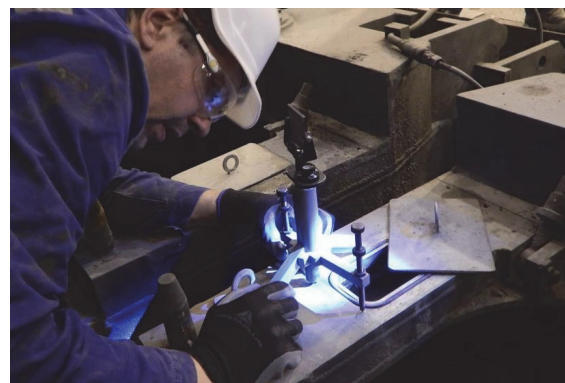
Рисунок 7. Контроль положения оборудования машины непрерывного литья заготовок с помощью измерительных приспособлений и электронного тахеометра.
