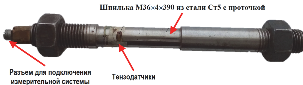
Рисунок 8. Внешний вид шпильки М36×4×390 с наклеенными тензорезисторными датчиками.
