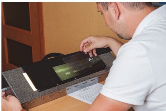
Рисунок 5. Расшифровка радиографических снимков с помощью негатоскопа и мерного трафарета.
