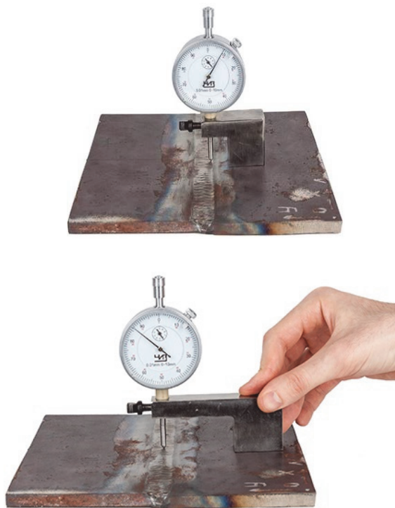
Рисунок 1. Внешний вид измерительных приспособлений для измерения глубины подрезов сварных соединений.
