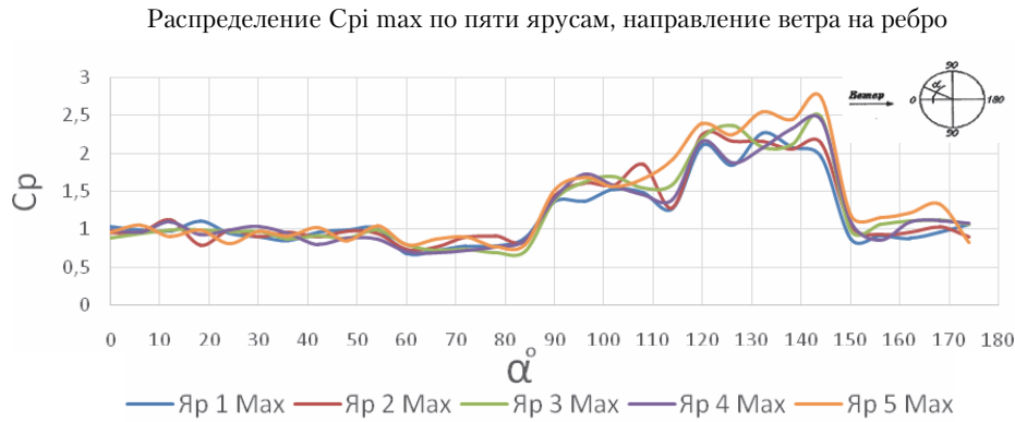
Рисунок 5. Распределение C_{pi} летний период эксплуатации, направление ветра на ребро. Распределение C_{pi} max по внутреннему контуру БМГ, направление ветра на ребро.
