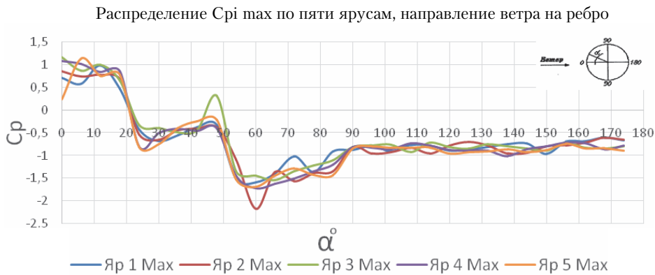
Рисунок 3. Распределение C_{pi} max по внешнему контуру БМГ, направление ветра на ребро (летний период эксплуатации).
