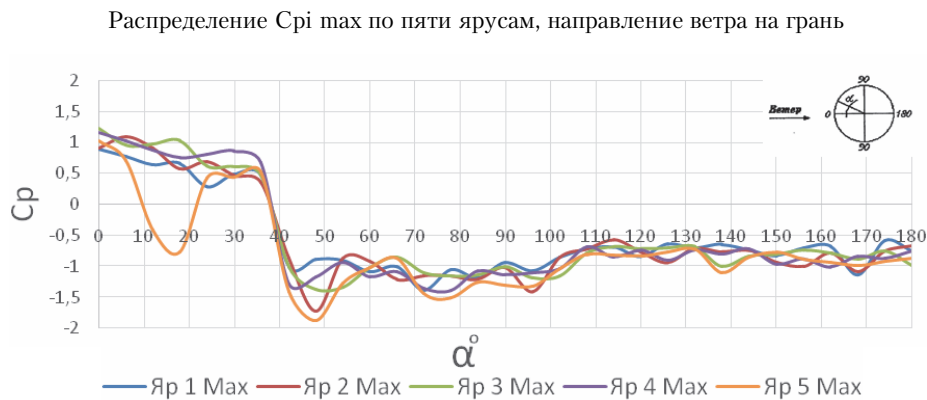
Рисунок 7. Распределение C_{pi} в зимний период эксплуатации. Распределение C_{pi} max по внешнему контуру БМГ, направление ветра на грань.
