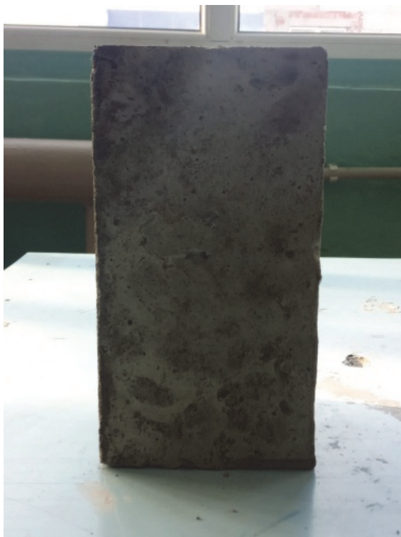
Рисунок 1. Экспериментальный образец – призма из бетона класса В15.
