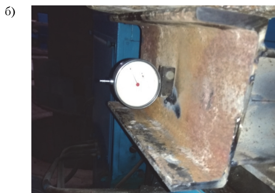
Рисунок 5. Экспериментальная установка с установленной горизонтальной силовой рамой, гидравлическим домкратом, бетонной призмой и индикатором часового типа ИЧ-10: а) сечение горизонтальной силовой рамы; б) индикатором часового типа ИЧ-10; в) горизонтальная силовая рама – вид сверху.
