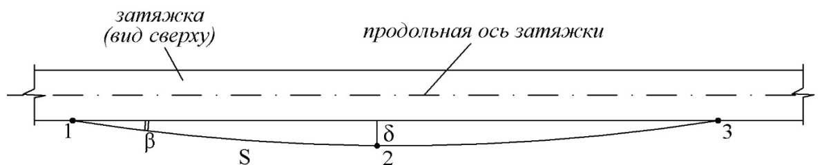
Рисунок 8 – Схема определения отклонения затяжки от ее продольной оси.
