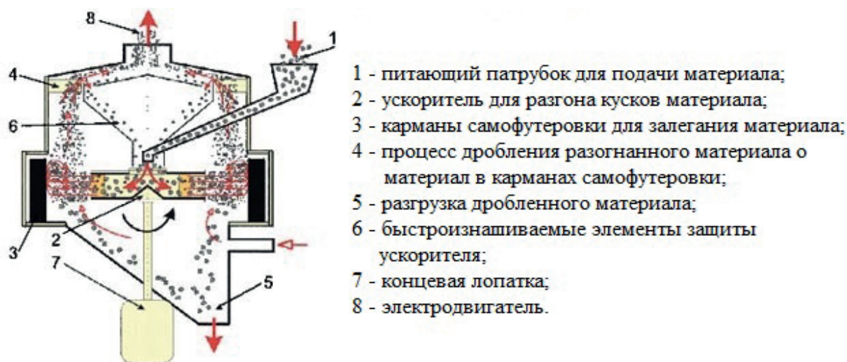
Рис. 7. Принципиальная схема центробежно-ударной дробильной установки
