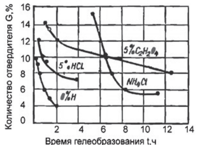
Рис. 1. Зависимость времени гелеобразования карбамидной смолы от вида и количества отвердителя
