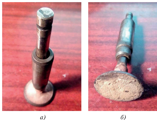
Рис. 4. Характерный вид выпускного клапана с направляющей втулкой (а) и состояния поверхности днища его тарелки (б) двигателя, выработавшего ресурс на КПГ
