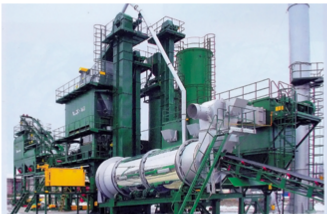
Рис. 7. Асфальтосмесительная установка ДС-168637 производительностью 160 т/ч (Кредмаш) по производству асфальтобетонных смесей на органических вяжущих, полученных из сливных отвалов КХЗ, АБЗ Краматорского райавтодора
