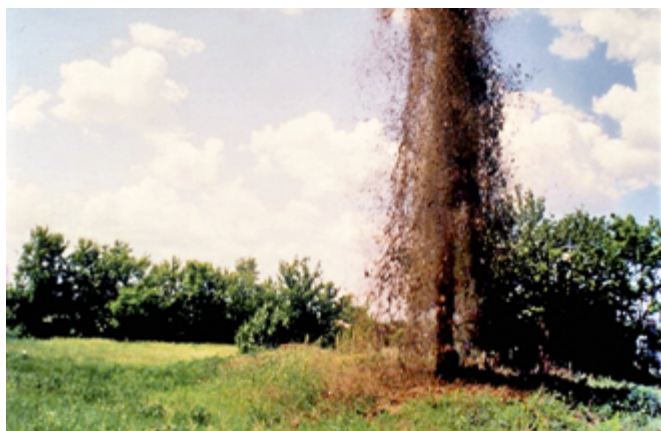
Рис. 4. Испытание по возобновлению дебита скважины, г. Донецк
