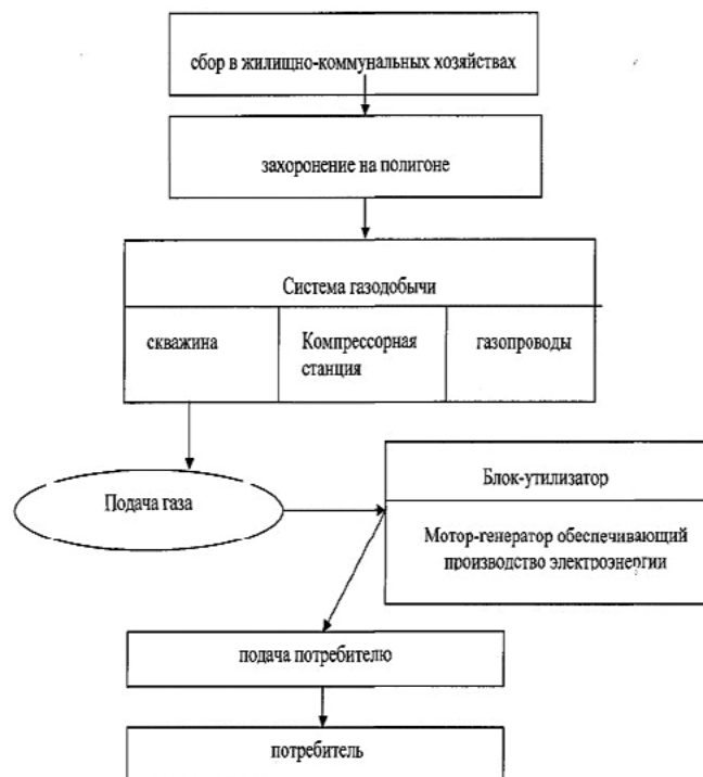
Рис. 2. Схема захоронения ТБО с дальнейшим получением и использованием биогаза в виде топлива или электроэнергии
