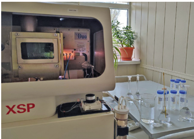
Рис. 2. Определение элементного состава карбонатных пород
