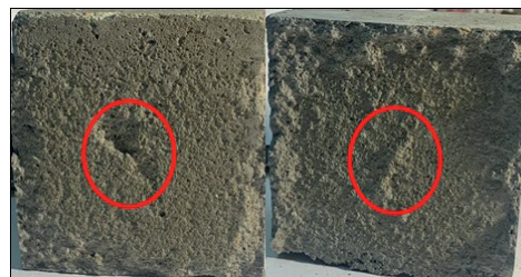
Рис. 13. Внешний вид поверхности образцов, выдержанных в агрессивных условиях и с термообработкой при укладке
