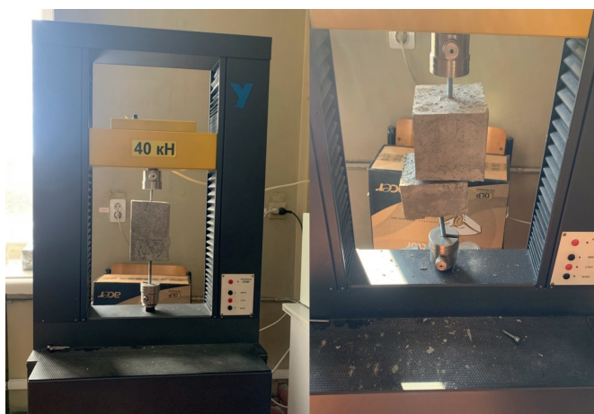
Рис. 10. Испытание образцов на осевое растяжение
