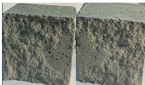
Рис. 12. Внешний вид поверхности образцов, выдержанных в нормальных условиях и с термообработкой при укладке
