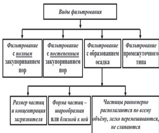
Рис. 2. Классификация видов фильтрования с образованием осадков: размерами, формой и степенью гидравлической характеристики
