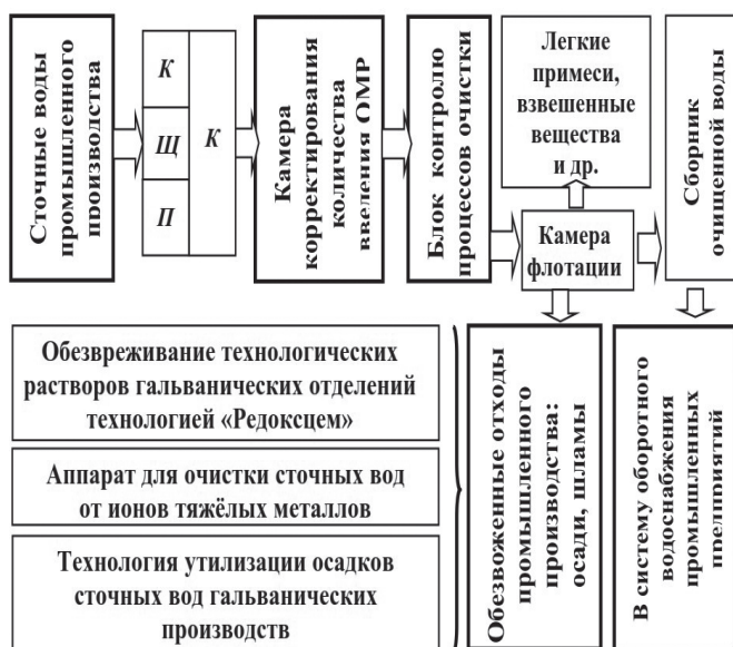
Рис. 2. Блок-схема обработки производственных сточных вод гальванических отделений с использованием реагентов электрохимическими методами. Приёмник-усреднитель стоков: К — концентрированные, К — кислые и П — промывные сточные воды [10, 11, 13-17]
