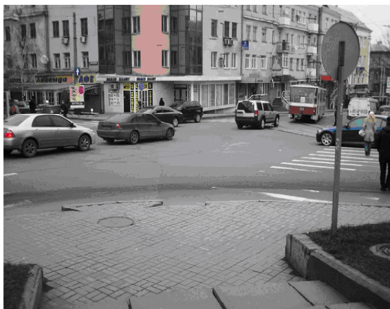
Рис. 1. Пешеходный переход на перекрестке ул. Постышева и ул. Челюскинцев на пл. Ленина. Пример относительно сложного участка пути на территории города. Отсутствие направляющих и ограждающих турникетов, рельефного мощения в местах подхода к проезжей части, а также других специальных элементов делают этот переход сложным для населения с сенсорными нарушениями.
