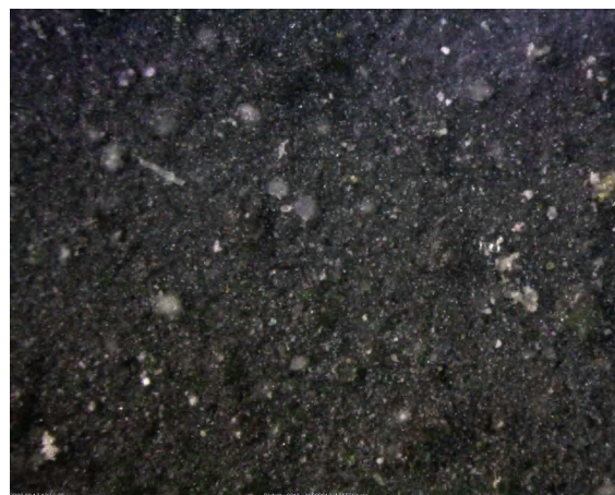
Рис. 10. Антикоррозионная композиция на основе гецементы, модифицированной добавками талька и оксида трехвалентного железа, после сушки при температуре 100 °С в течение 30 мин, отвержденной Са-содержащей добавкой в количестве 2,5 % от массы гецементы.
