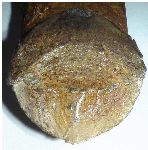
Рис. 9. Характер разрушения на изломе скобы СК-12.1.
