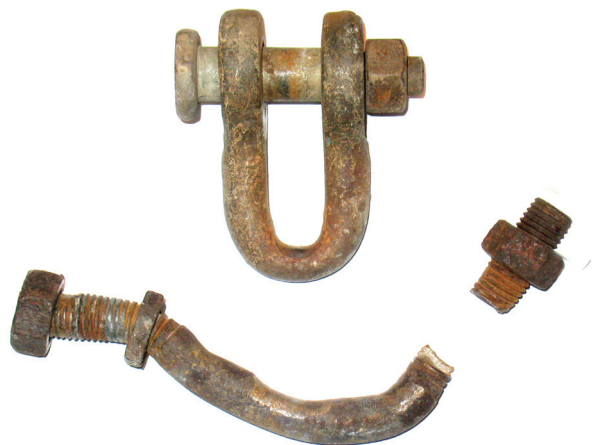
Рис. 4. Разрыв U-образного болта. Опора № 473 ВЛ 330 кВ «Мелитопольская – Джанкой».
