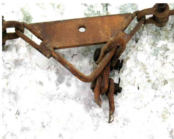
Рис. 6. Разрыв скобы СК-12.1 на Л-образной подвеске. Опора № 277 ВЛ 330 кВ «Каховская – Джанкой».
