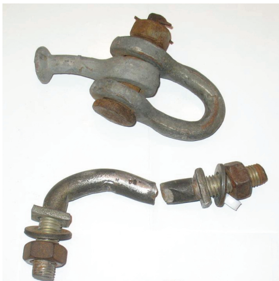
Рис. 8. Разрыв U-образного болта. Опора № 260 ВЛ 330 кВ «Каховская – Островская».
