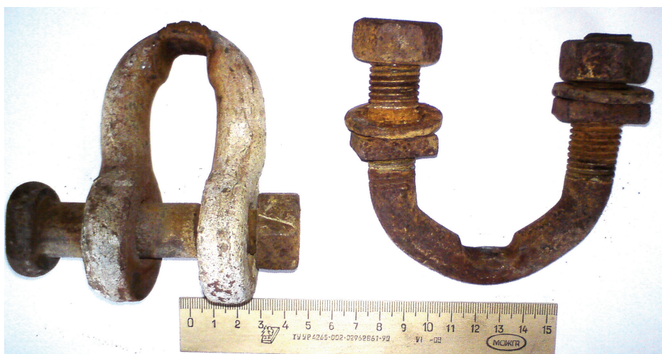
Рис. 2. Механический износ элементов узла КПП.
