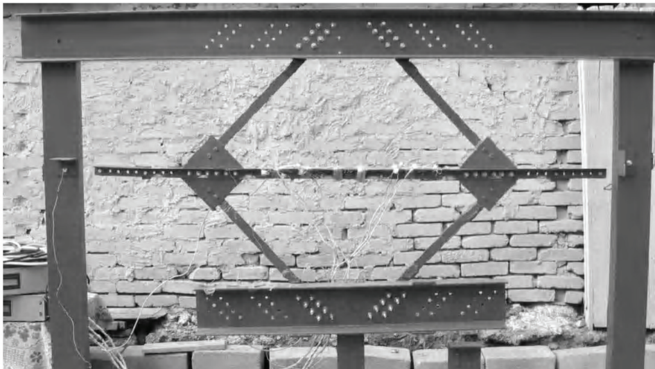
Рисунок 2. Изменение эффективной длины испытываемого элемента на разных этапах испытаний.
