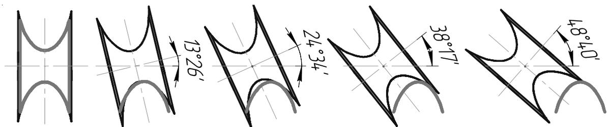
**Рисунок 6.** Схема смещение ленты шириной 800 мм при развороте барабана имеющего форму цепной линии.
