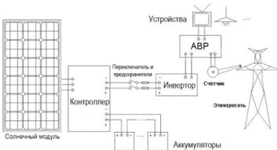
Рисунок 2. Типовая схема комплектации фасадной солнечной батареи.
