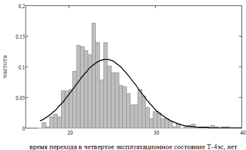
Рисунок 5. Гистограмма распределения смоделированного времени перехода пролетных строений в четвертое эксплуатационное состояние Т-4эс.
