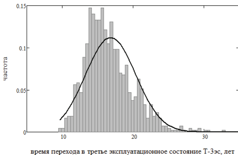
Рисунок 4. Гистограмма распределения смоделированного времени перехода пролетных строений в третье эксплуатационное состояние Т-3эс.
