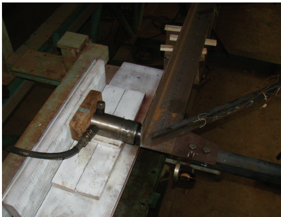
Рисунок 10. Узел установки гидравлического домкрата ДГ-10.
