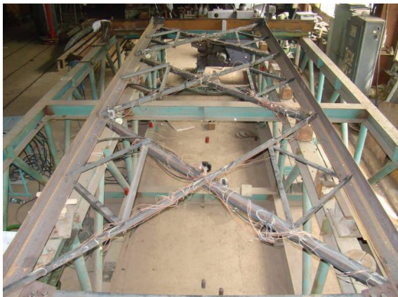
Рисунок 8. Общий вид испытуемой фермы (решетка L63 × 5).
