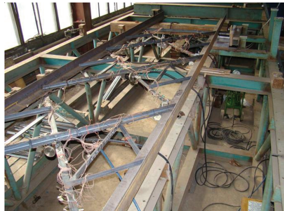
Рисунок 9. Общий вид испытуемой фермы (решетка L45 × 4).
