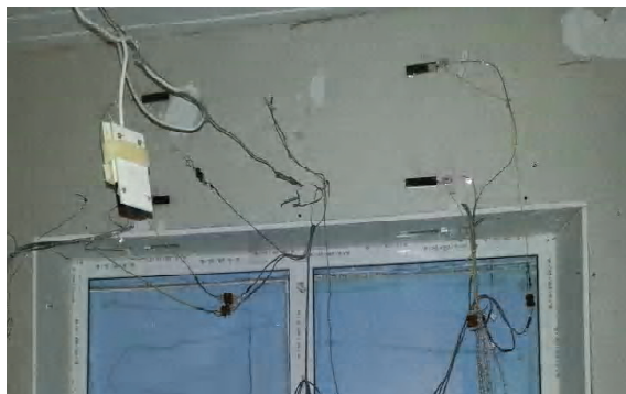
Рисунок 4. Исследованный оконный проем: а) общий вид; б) схема расположения датчиков температуры.
