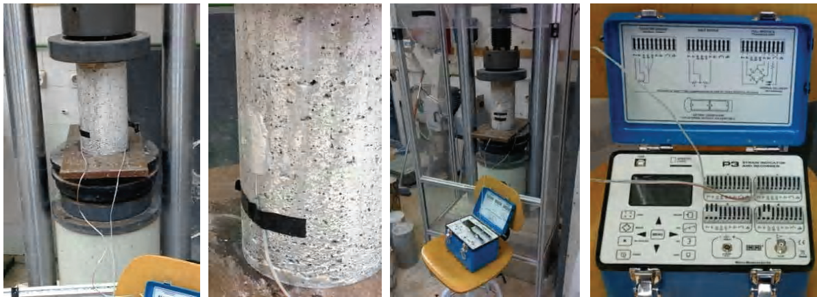
Рисунок 2. Экспериментальное определение модуля упругости самоуплотняющегося бетона.
