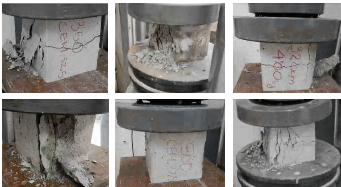
Рисунок 2. Процесс испытания образцов самоуплотняющегося бетона.
