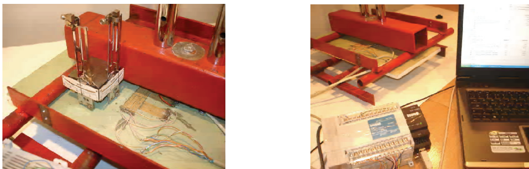
Рисунок 3. Контроль деформаций с помощью тензорезисторов и тензометров Гугенбергера.
