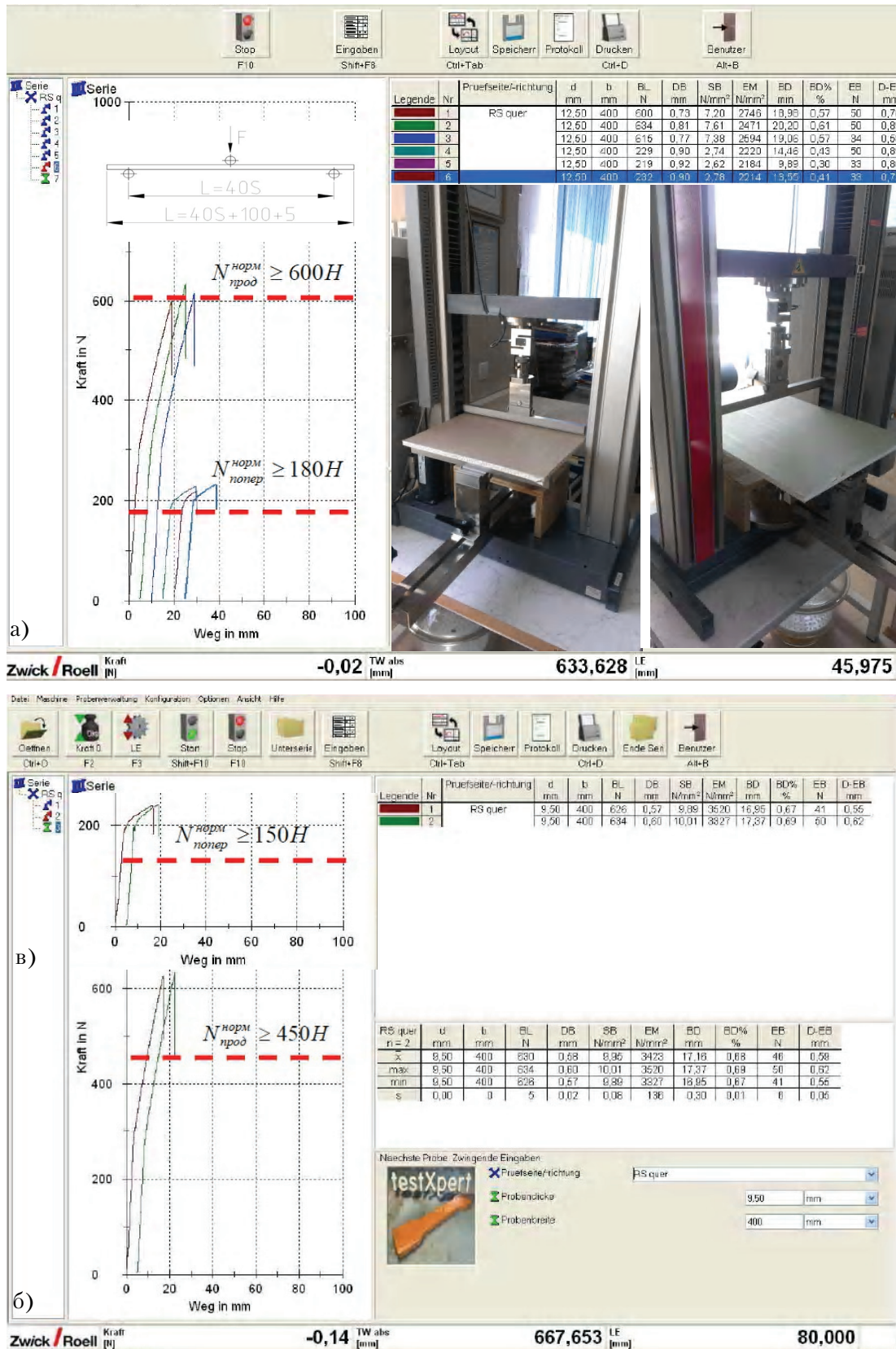
Рисунок 1. Результаты испытания по ГОСТ 6266-97 при переменном пролете продольных и поперечных образцов из: а) ГКП 12,5 мм, б), в) ГКП 9,5 мм на сертифицированном оборудовании Zwick Roell.
