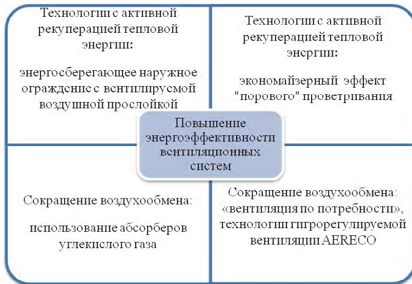
Рисунок. Направления повышения энергоэффективности вентиляционных систем.
