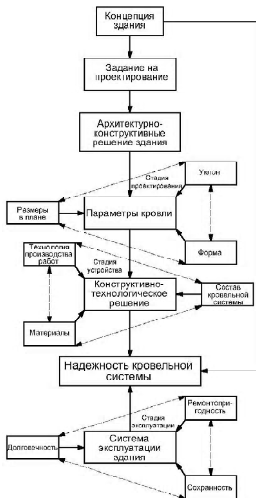
Рисунок 1. Концепция надёжности кровельной системы.
