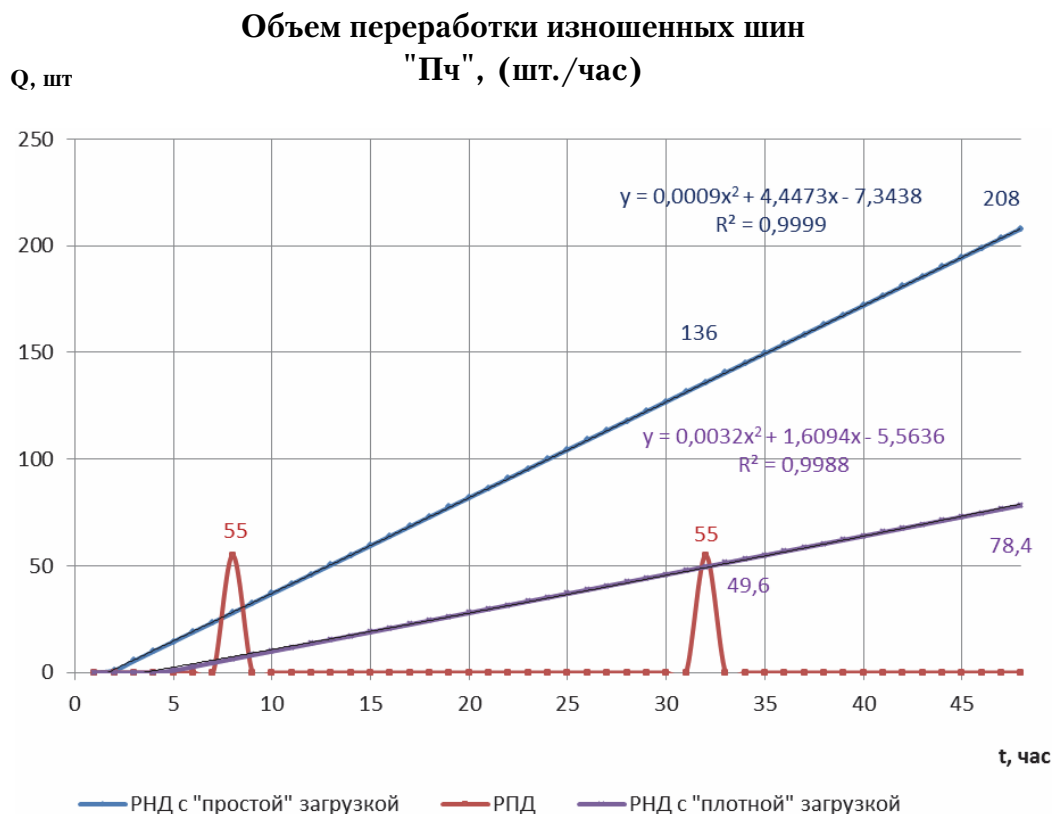
Рисунок 3. Диаграмма часовой производительности пиролизных реакторов в период выхода на номинальную мощность.
