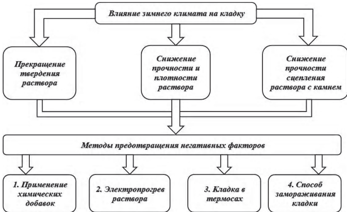
Рисунок 2. Схема методов выполнения каменной кладки в зимний период.
