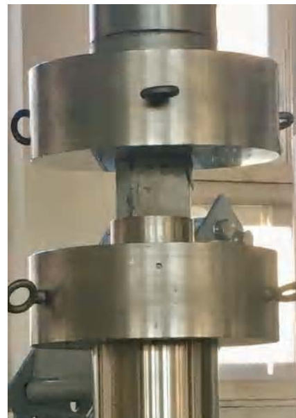
Рисунок 5 – Испытание образцов-кубиков на прочность: а) пресс UTM-4500; б) испытание образцов.
