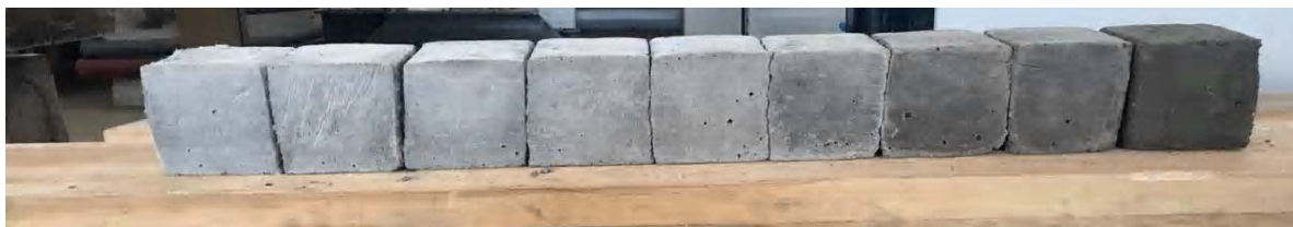
Рисунок 4 – Полученные цементно-песчаные образцы-кубики размером 70×70 ×700 мм после их выдерживания в условиях градиента температур.
