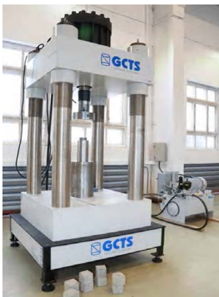
Рисунок 5 – Испытание образцов-кубиков на прочность: а) пресс UTM-4500; б) испытание образцов.
