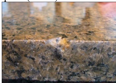
Рис. 2 Частое место образования сколов - ребро гранитной плиты.
