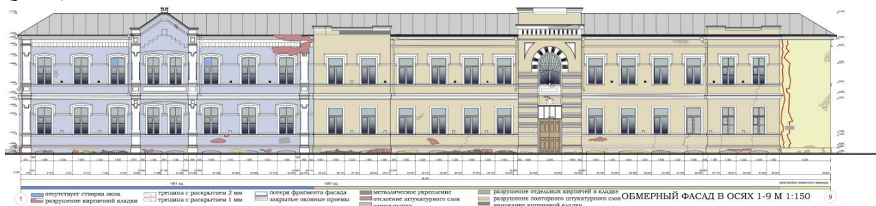
Рисунок 3 - Фасад здания по ул. М. Максакова «Дом ночлежный городской» с выявленными дефектами. [3]
