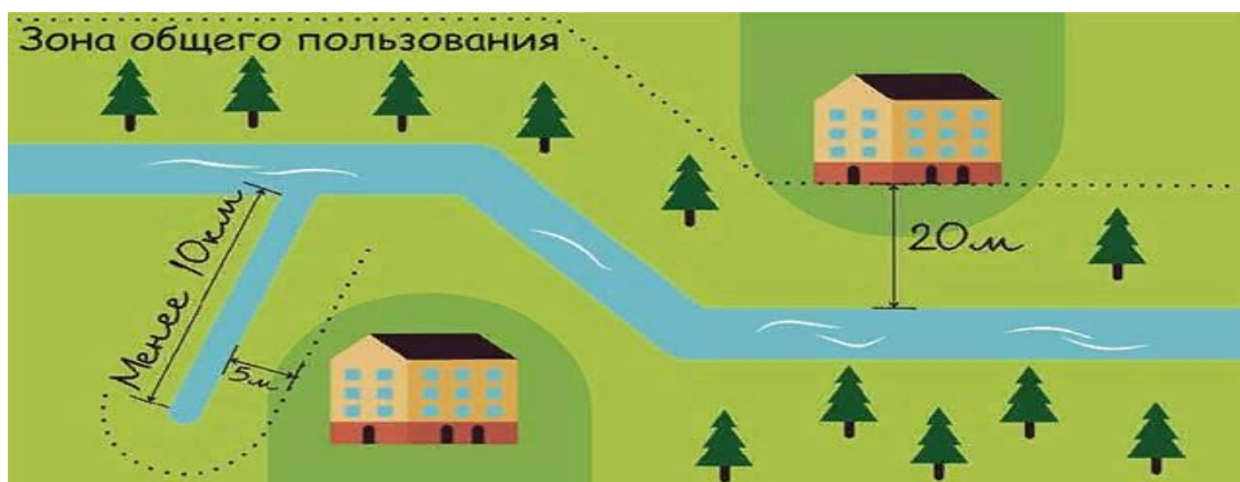
Рисунок 2 - «Расположение зданий и сооружений в прибрежно-защитной полосе»
