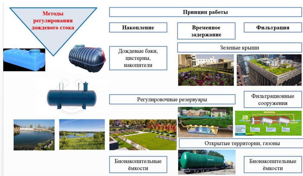
Рисунок 1 – Классификация методов управления дождевым стоком в зависимости от принципа их работы
