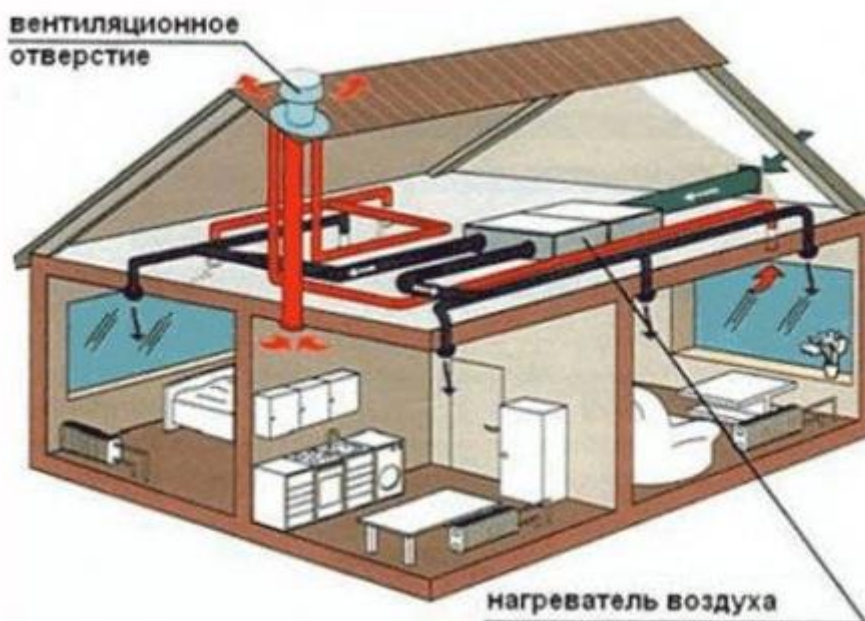
Рисунок 4 - Принципиальная схема воздушного отопления в частном доме
