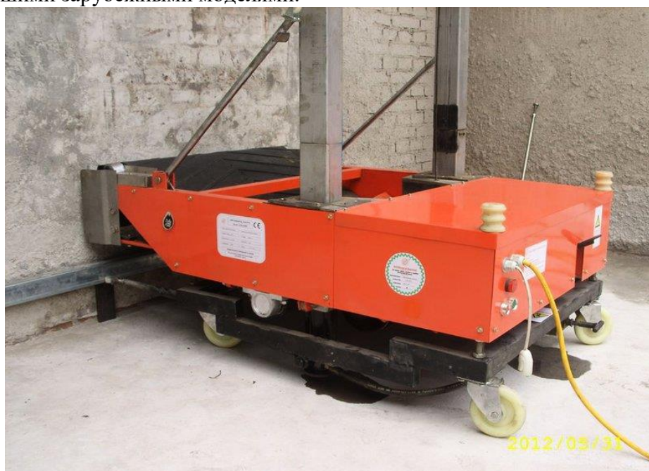
Рисунок 1 - Робот-штукатур RoboPlaster-1000 (Производительность от 60 до 90 м 2 в час 7 , максимальная высота - до 5 метров , стоимость - 325.000Р)
