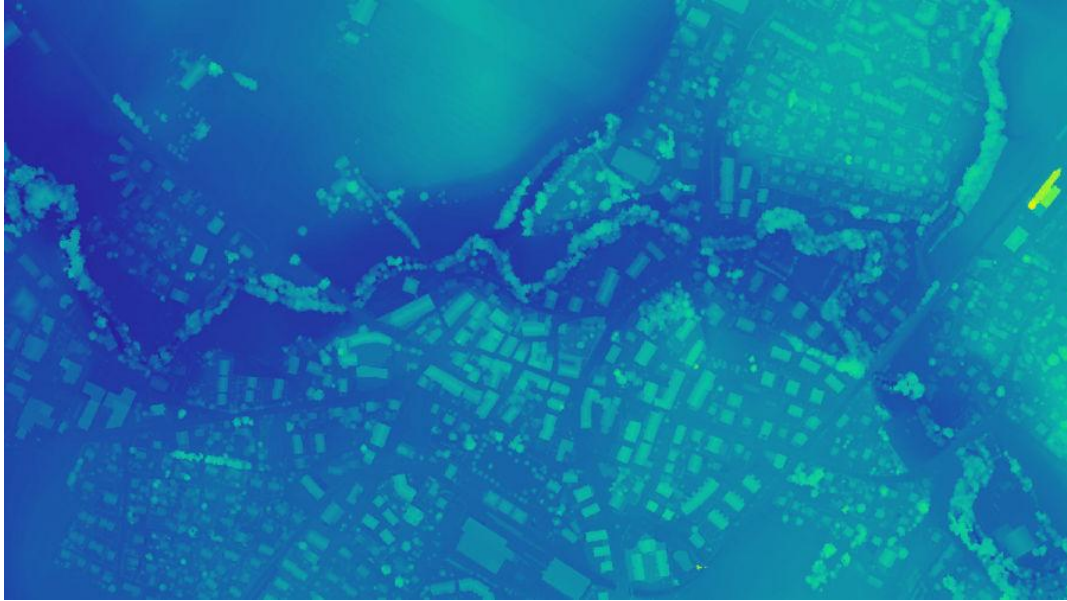
Рис. 2. Цифровая модель рельефа с использованием фильтра высот Pix4D [4]
