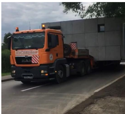
Рис. 1. Перевозка сверхкрупногабаритных модулей
