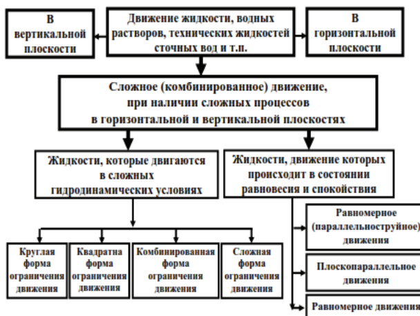
Рисунок. Блок-схема движения частиц водных потоков внутри аппаратов напорной флотации-коагуляции систем промышленного водоснабжения.
