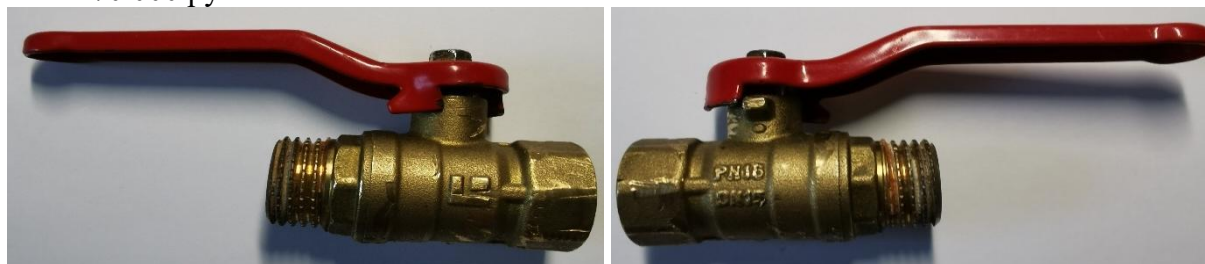
Рисунок 1 — Шаровый кран, демонтированный с узла ввода
