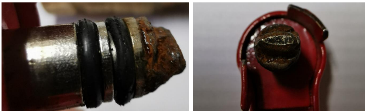
Рисунок 2 — Разрушенный шток крана с местом излома и следами коррозии
