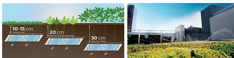
Рисунок 4.—Система подземного полива зеленых крыш и поверхностная система полива – орошение
