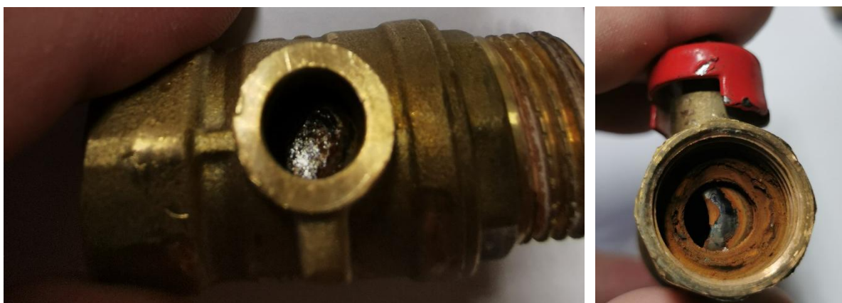
Рисунок 3 — Место излома штока в корпусе шарового крана и внутренней коррозии
