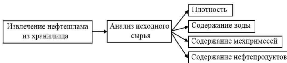
Рисунок 1 - Стадии первичной обработки и анализа нефтешлама
