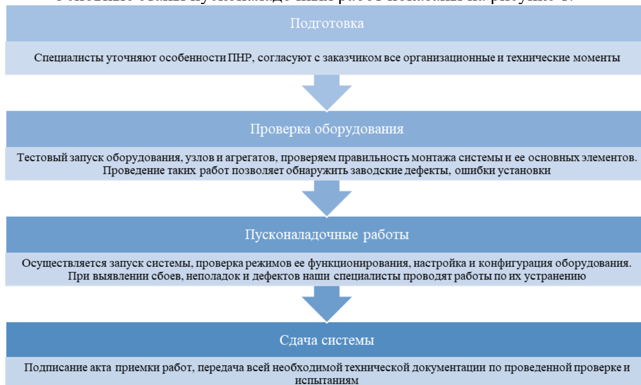
Рисунок 1 – Основные этапы пусконаладочных работ
