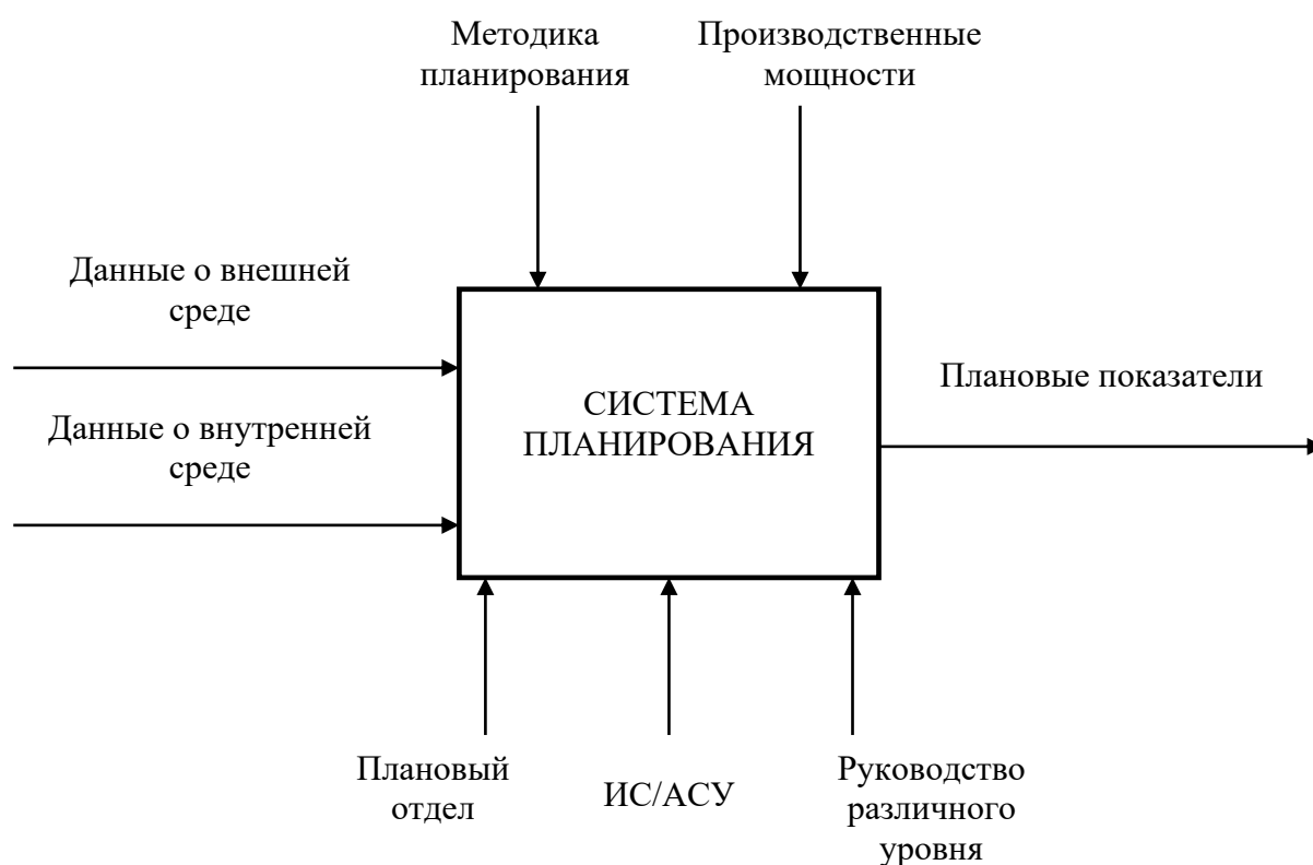
Рисунок 1 – Контекстная диаграмма IDEF0 «Процесс планирования»
