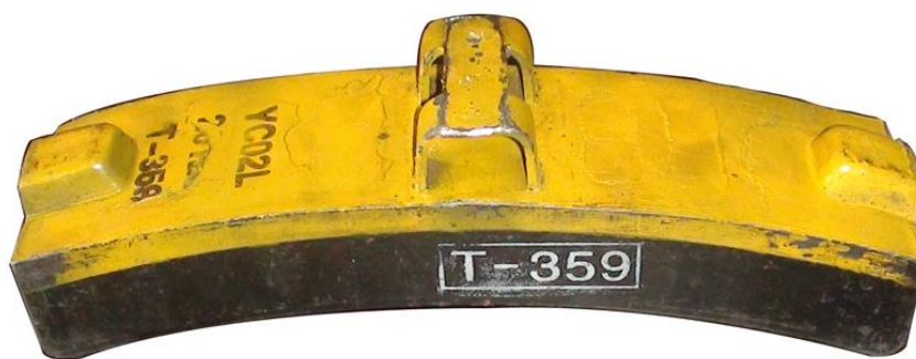
Рисунок 1. Композитная тормозная колодка
