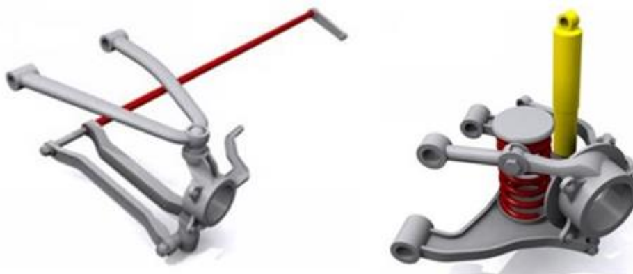
Рисунок 3. Передняя подвеска: слева – торсионная, справа – пружинная.
