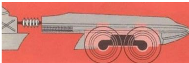
Рисунок 3. Схема крепления силового агрегата к автомобилю
