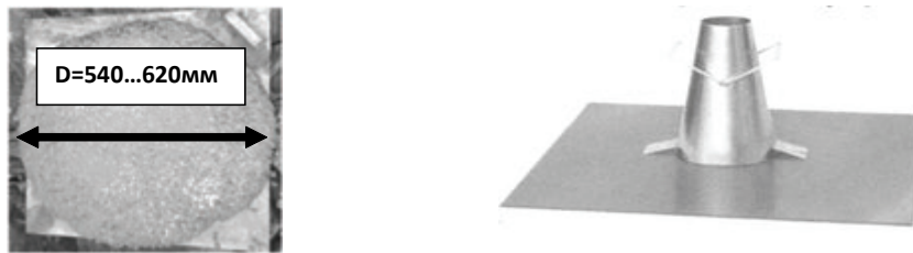
Рисунок 4 – Контроль подвижности и отсутствия эффекта расслоения СУБ.
