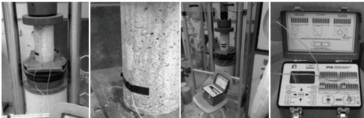
Рисунок 6 – Экспериментальное определение модуля упругости самоуплотняющегося бетона.
