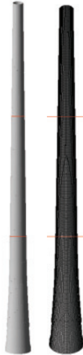
Рисунок 1 – Расчетная схема модели железобетонной трубы Н = 250 м.
