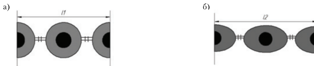
Рисунок 6 – Схема деформации демпфирующих элементов дорожного ограждения при взаимодействии с движущимся автомобилем: а) форма демпфирующего элемента в недеформированном состоянии; б) форма сечения демпфирующего элемента при деформации от взаимодействия с движущимся автомобилем.
