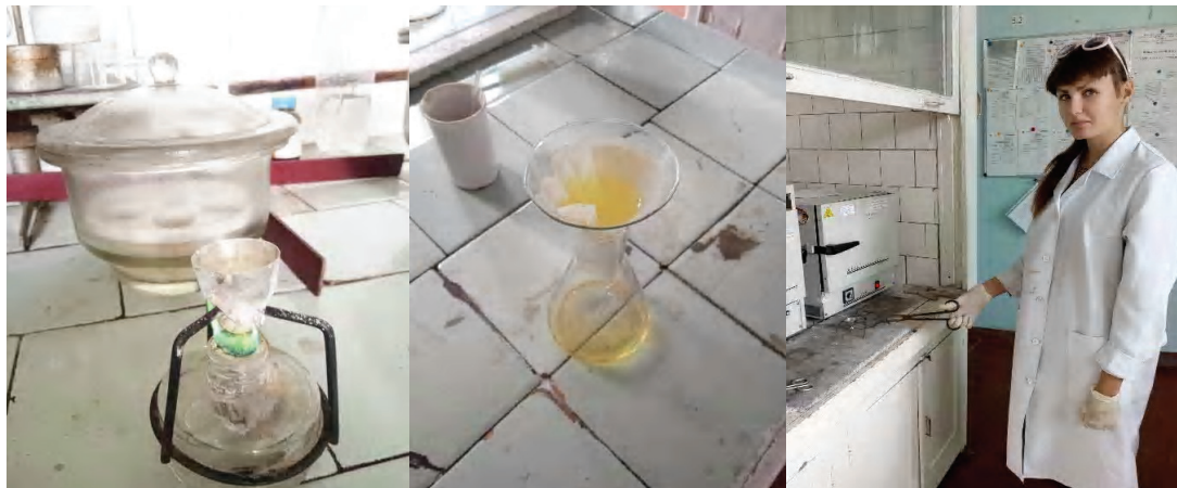
Рисунок – Определение объемного содержания полуторных оксидов металлов в образце отвальной породы.
