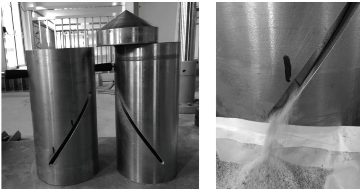
**Рисунок 1** – Конструкция внешних оболочек регулируемого фундамента «песочницы» – прототипа.
