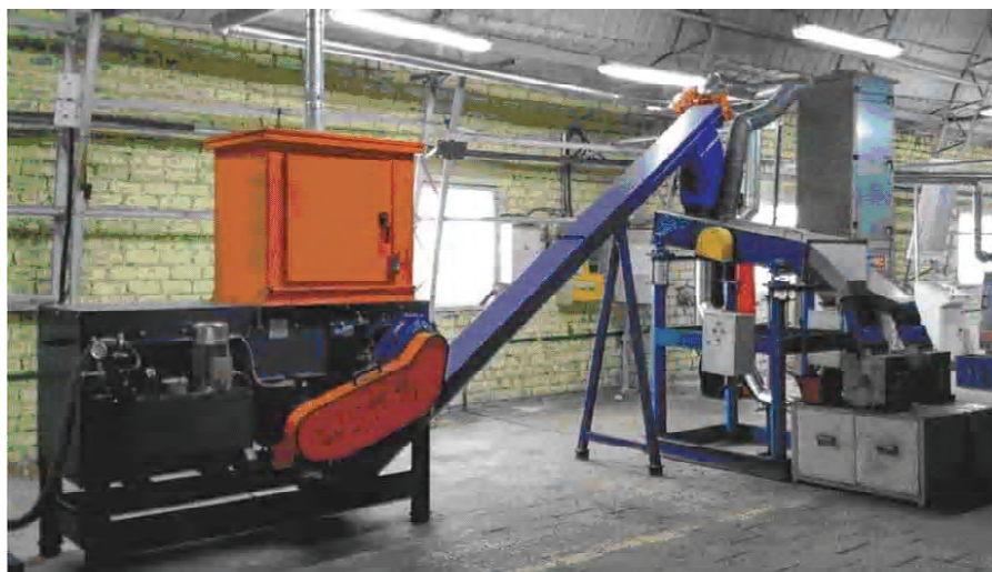
Рисунок 2 – Установка дробления батареек WS 15-11.
