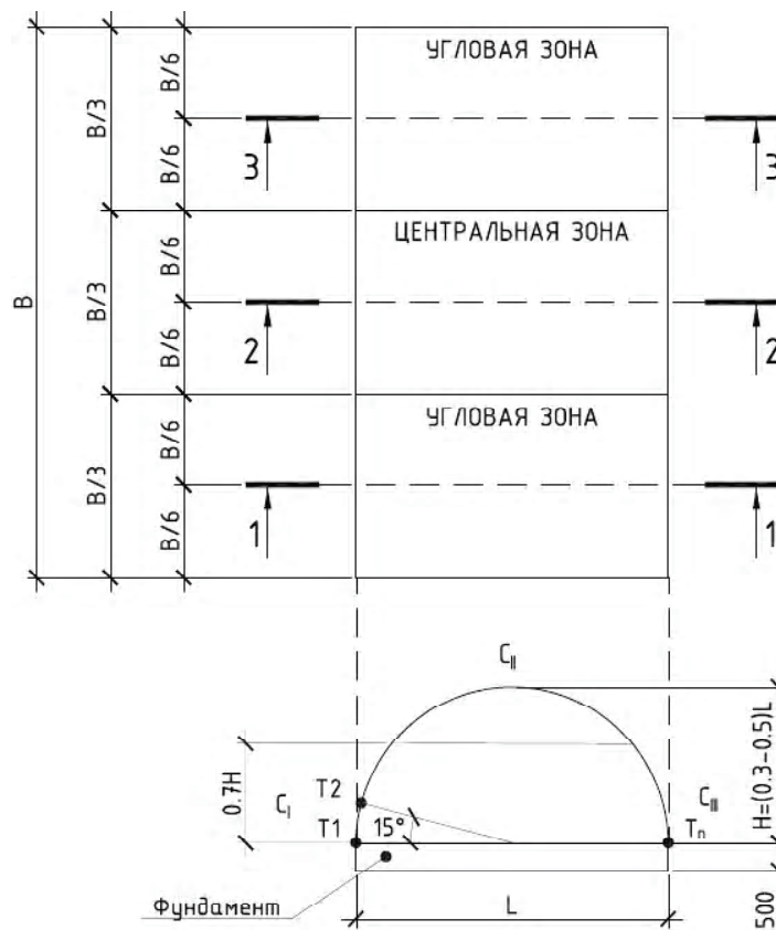
Рисунок 3 – Схема расположения контрольных точек и сечений.
