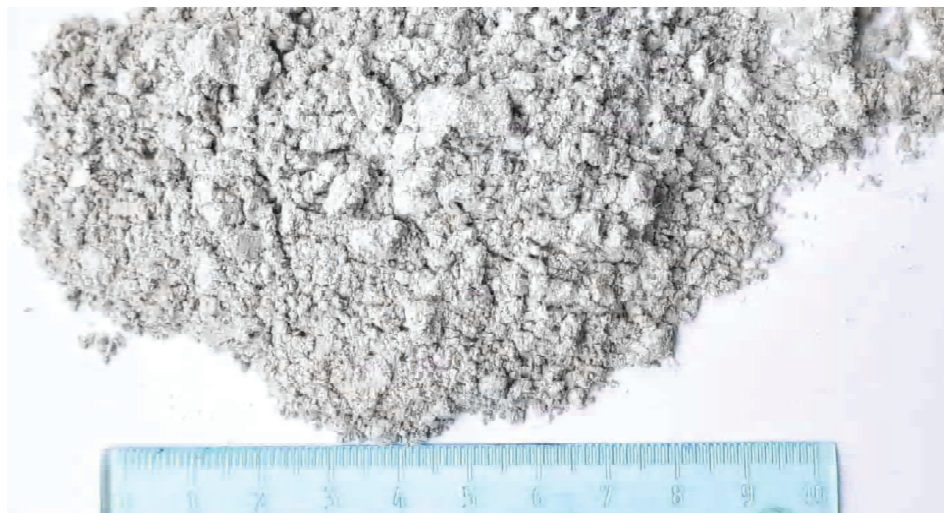
Рисунок 2 – Хризотил-асбестовые волокна марки 6к-30, применяемые в данной работе.
