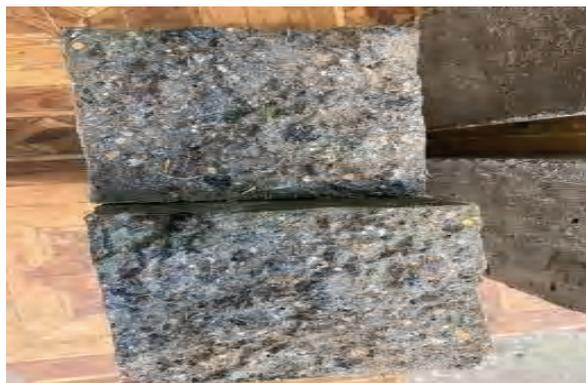
**Рисунок 9** – Поперечное сечение изгибаемого образца балки из бетона, армированного кокосовым волокном.
