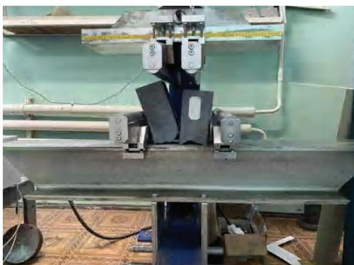
Рисунок 5 – Испытание на изгиб обычных железобетонных элементов балки.
